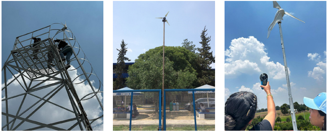
Figura 6. Monitoreo del recurso eólico disponible en la Casa Solar Campesina Fuente: elaboración propia.
