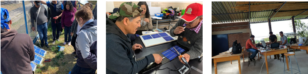
Figura 5. Manufactura de módulos e instalación de módulos comerciales en la Casa Solar Campesina Fuente: elaboración propia.
